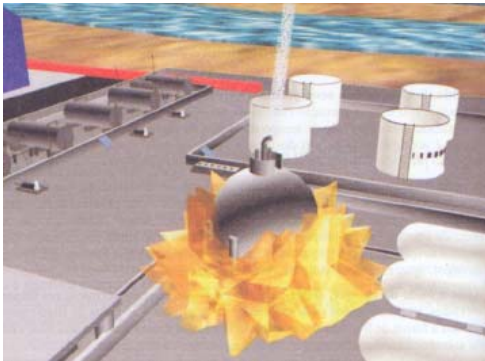
Esfera envolvida em chamas com abertura de válvulas de segurança
