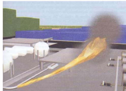
Contato com fonte de ignição forma o Jato de Fogo.
